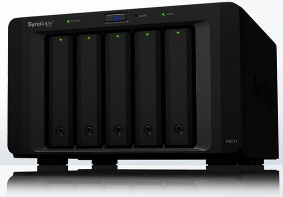
Synology DX517 は、その直観的なプラグアンドユースのデザインで、お使いの DiskStation に対するシンプルなストレージ容量拡張ソリューションとなります。DX517 により、RAID ボリュームをオンラインに拡張またはドライブを DiskStation の専用ローカルバックアップ先として配備するため、最大 5 台の追加ハードドライブを即座にスケールアップできます。Synology DX517 にはお客様が安心してご利用いただけるように Synology の 3 年間保証がついています。
