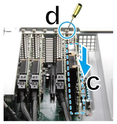
c Alinee el conector de la tarjeta con la ranura de expansión e inserte la tarjeta en la ranura.
