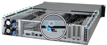
**b** Vuelva a colocar y a apretar el tornillo que retiró en el paso 2-a.
