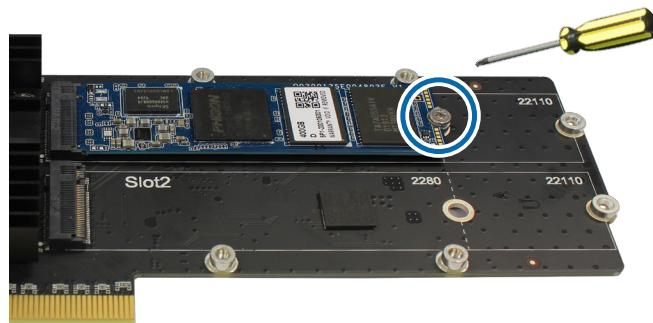
**d** 如需安装另一个 M.2 SSD，请重复前三个步骤。插槽排序编号如下。
