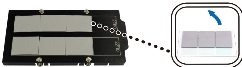
**f** 用四颗螺丝拧紧散热器。请确保散热器牢固地连接到适配器卡，以确保 M.2 SSD 平稳运行。
