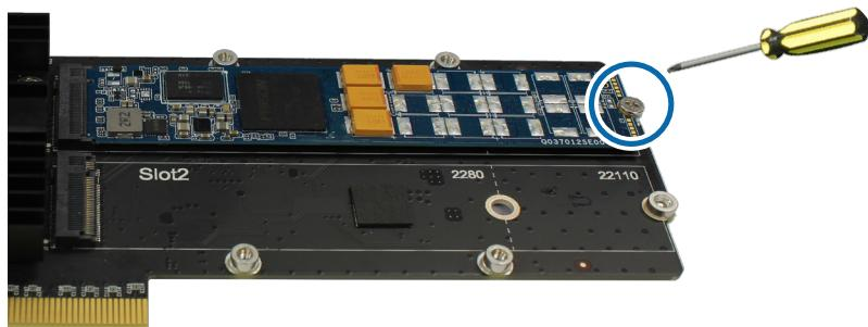
c 从散热垫上撕下保护膜，然后将散热垫贴到 SNV3500-400G 的控制器上。将橡胶装在螺丝柱旁。
