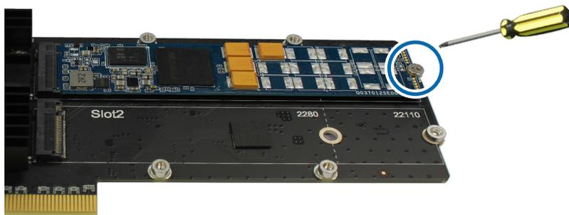
c 移除用來保護導熱片的透明片，再將導熱片貼至 SNV3500-400G 的控制器上。將墊片貼至螺絲銅柱旁。
