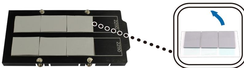
f 用四顆螺絲固定散熱鰭片。確認散熱鰭片已牢固固定至轉接卡，以確保 M.2 SSD 順利運行。
