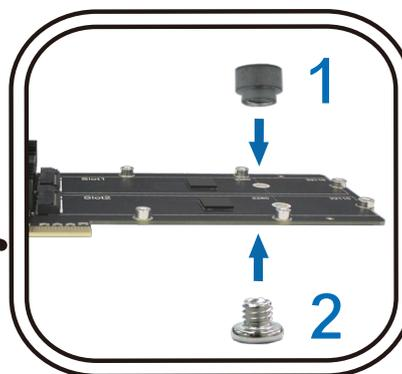
b SNV3400-400G をスロットに挿入します。カードが完全に挿入されていることを確認します。
