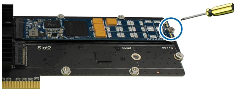
c Remova a película protetora da almofada térmica e prenda a almofada ao controlador do SNV3500-400G. Prenda a borracha ao lado da coluna de parafuso.
