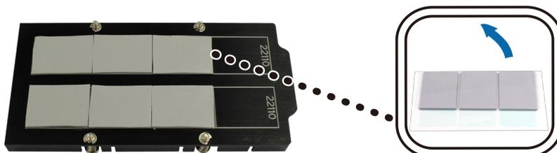
f Aperte o dissipador de calor com quatro parafusos. Certifique-se de que o dissipador de calor esteja firmemente conectado à placa de adaptador para assegurar o bom funcionamento da SSD M.2.
