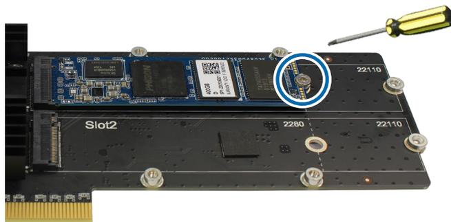
d Repita los tres pasos anteriores si necesita instalar una unidad SSD M.2 adicional. Las ranuras se numeran de la siguiente manera.
