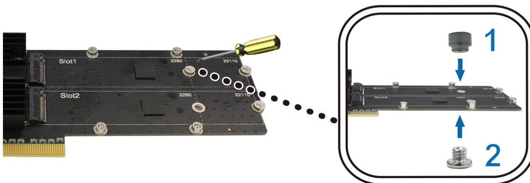
b Inserte la SNV3400-400G en la ranura. Asegúrese de que la tarjeta esté totalmente insertada.
