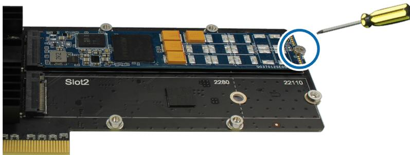
c Retire la película protectora de la almohadilla térmica y acople la almohadilla térmica al controlador de la SNV3500-400G. Coloque la goma junto al tornillo espaciador.
