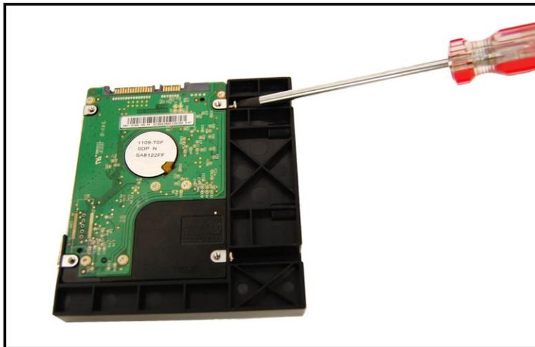
将2.5吋硬盘架滑入硬盘托架，并确实推紧使硬盘接上连接接头。使用两颗硬盘螺丝从侧边将硬盘架固定。
