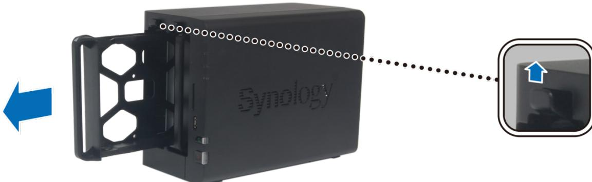
**3 将硬盘装在硬盘驱动器托架中。**
