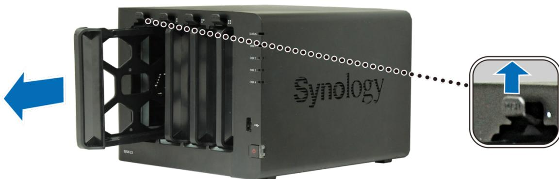
3 将硬盘装在硬盘驱动器托架中。
