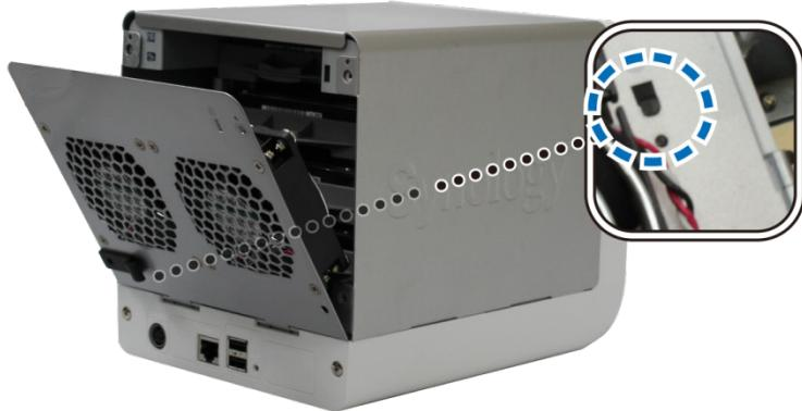
**9** 关闭后方面板。装回上盖，并锁紧您在步骤 1 中取下的 4 颗螺丝。
