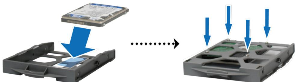
**4 将装好的硬盘托盘放入空的硬盘插槽。**
