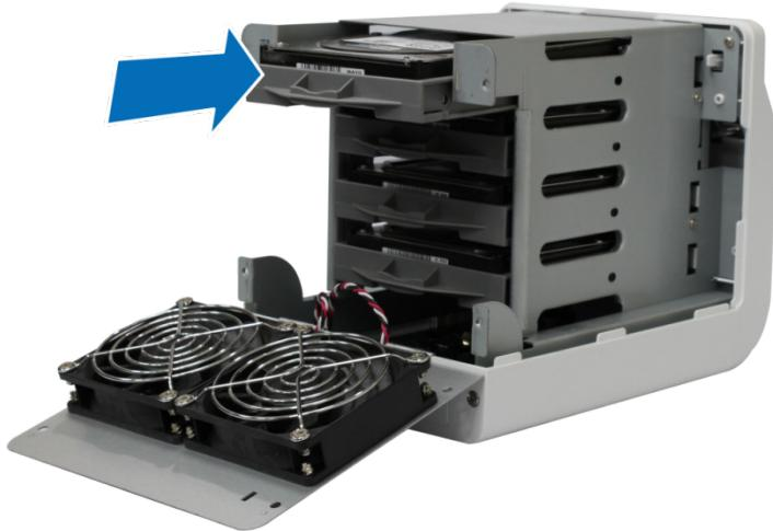
**重要提示：**请确定已将托盘完全推入。否则，硬盘可能无法正确运作。
