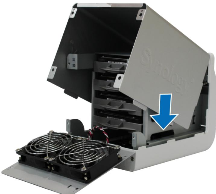
**8** 将固定卡钩固定到后方面板上的孔位。请确定在后方面板的内面，固定卡钩已勾上。
