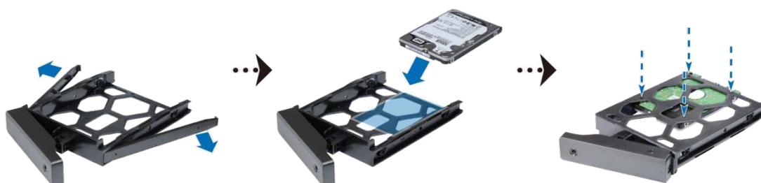
4 将托盘置入空的硬盘插槽。按入把手直至卡入到位。
