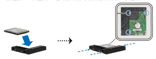
b 将硬盘托架插入硬盘插槽,并将其推入直至与 SATA 接头稳固连接。请使用提供的螺丝来固定硬盘托架。
