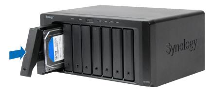
注: 请确定已将托盘完全推入。 否则,硬盘可能无法正常运作。
