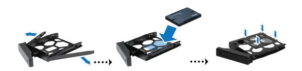
4 将装好硬盘的托架放入空的硬盘插槽。
