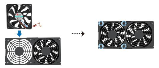
b 将 2 条风扇线缆连接到风扇插座底部附近的接头,然后更换风扇面板。
