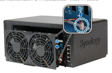
c 松开用来固定故障风扇的 4 颗螺丝,然后卸下风扇。
