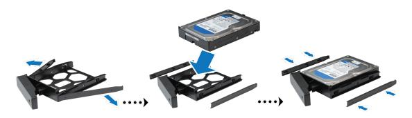
• 对于 2.5 吋硬盘: 卸下托盘侧面的紧固板并存放在安全的地方。将硬盘置于托盘的蓝色区域(如下图所示)。将托盘翻转朝下,并拧紧螺丝来固定硬盘。
