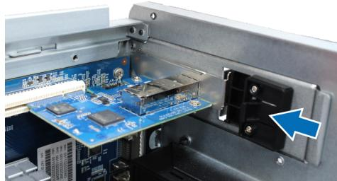
**注：**请确定接头已完全插入。否则，网络接口卡可能无法正常工作。
