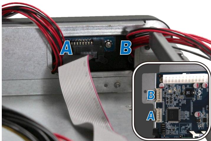
**b** 装回内部面板，并锁紧您在步骤 2-b 中取下的 7 颗螺丝。
