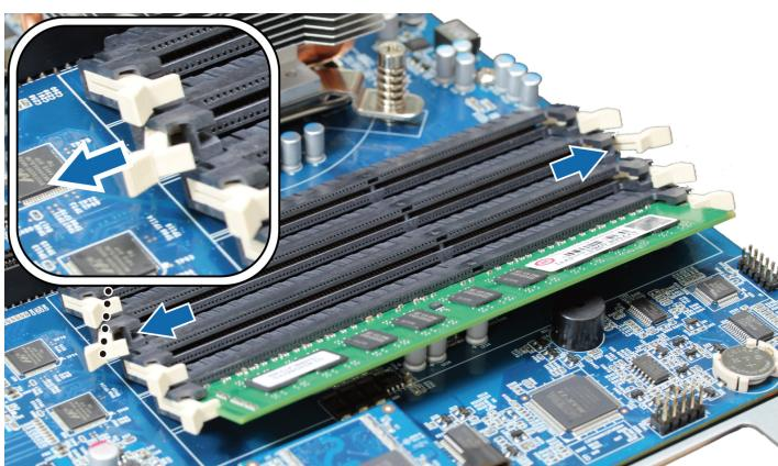
**b** 将模块金属边缘上的缺口与内存插槽中的缺口对齐。
