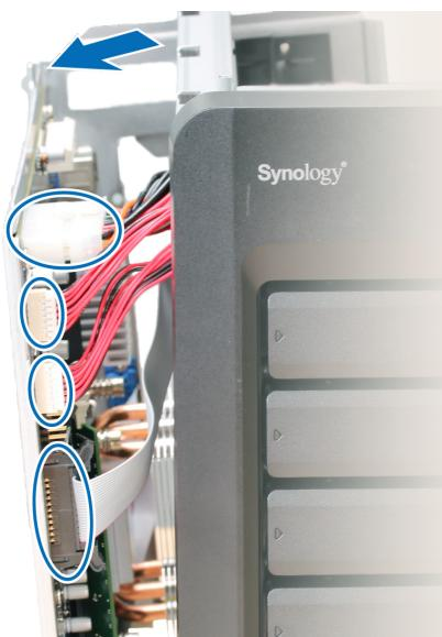
d 放下内部面板，两根线缆仍连接到其底部）。如果您在安装内存模块时需要更多空间，可选择拔下线缆。
