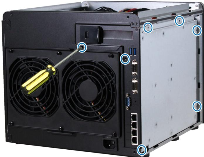
**注：**当您卸下护盖时，您已暴露了内部的敏感组件。移除或添加内存时，请避免触碰到除内存外的其他组件。
