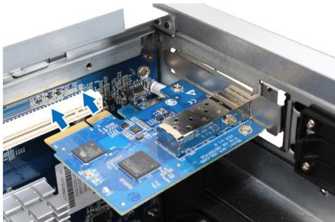
d タブを再度押すと、新しい挿入されたカードが固定されます。
