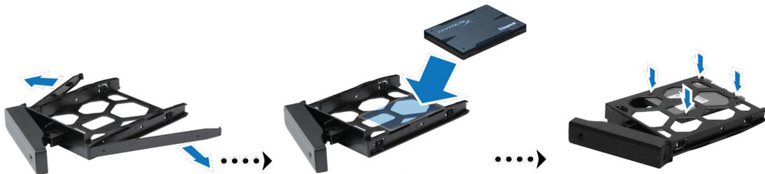
4 ロードしたハード ドライブ トレイを空のハード ドライブ ベイに挿入します。
