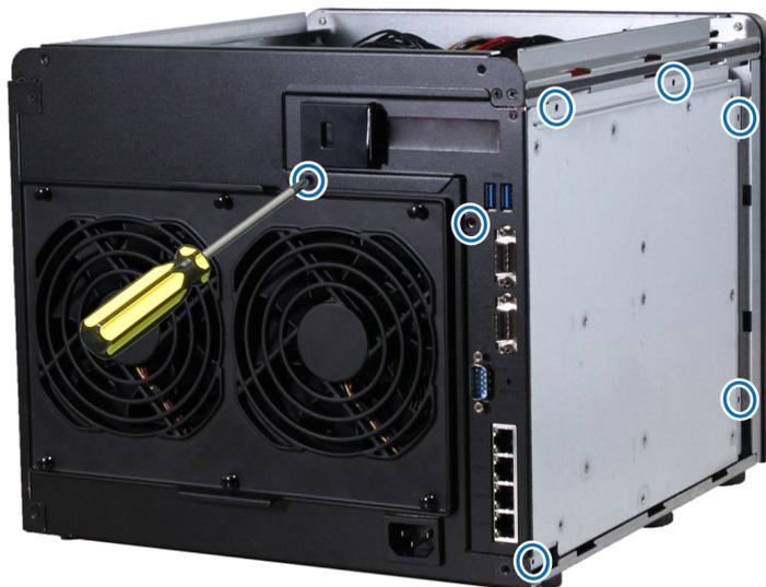
**注：** ケースを外すと、内部の繊細なコンポーネントが見えます。メモリの取り外しや追加を行う場合は、メモリ組立部品以外のものに触れないでください。
