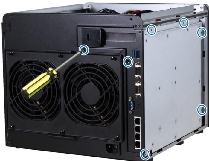
**Observação:** Ao remover a tampa, componentes internos delicados ficarão expostos. Evite tocar em qualquer parte além do conjunto da memória quando remover ou adicionar uma memória.
