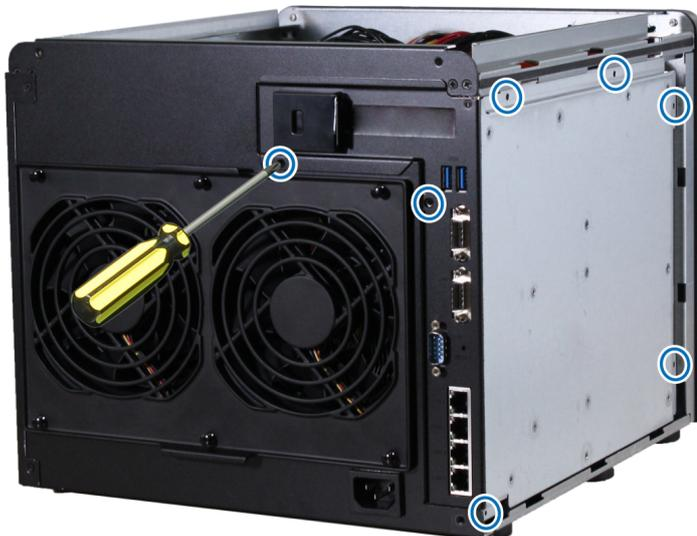
**Nota:** Ao remover a tampa, ficam expostos componentes internos sensíveis. Evite tocar em algo para além da montagem da memória quando remover ou adicionar memória.
