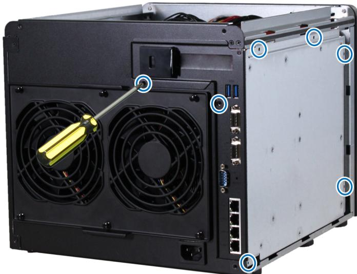
**Примечание.** При снятии крышки вы подвергаете чувствительные внутренние компоненты внешнему воздействию. Не трогайте внутренние компоненты за исключением блока памяти, который вы собираетесь извлечь или добавить.
