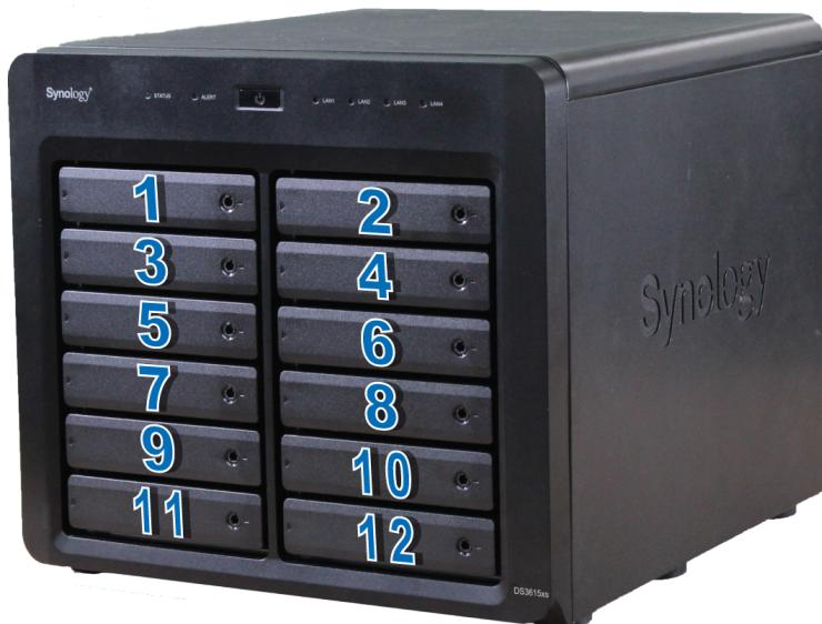
**Примечание.** При необходимости создать раздел RAID рекомендуется, чтобы все установленные жесткие диски были одного размера для максимального использования дискового пространства.
