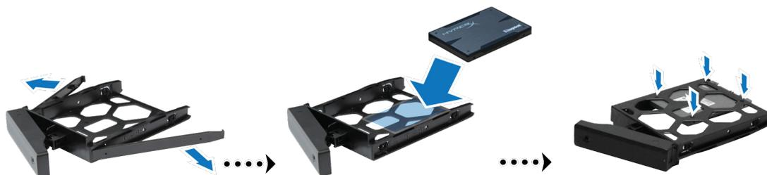
**4** Inserte la bandeja del disco duro cargada en el receptáculo de discos duros vacío.
