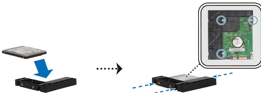
b 将 2.5 吋硬盘托架插入硬盘插槽，并将其推入直至与 SATA 接头稳固连接。用提供的螺丝来固定硬盘托架。
