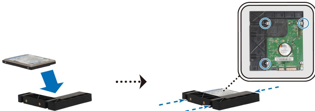
**b** 將 2.5 吋硬碟架滑入硬碟插槽並推入至底，使硬碟接上 SATA 接頭。使用附上的螺絲來固定硬碟架。
