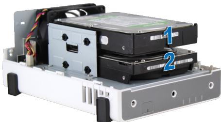
**注意：** RAID ボリュームを構築する場合は、取り付けたすべてのディスクを同じサイズにして、ディスク容量を最も有効に使えるようにしてください。
