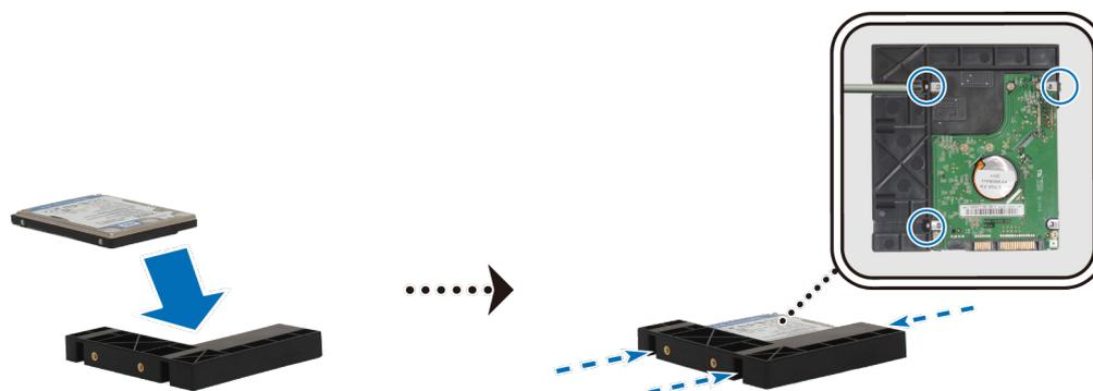
b 2.5" インチ用ディスクホルダをハードドライブ用ベイにスライドさせて挿入し、ドライブが SATA コネクタに接続されるまで押し込みます。ディスクホルダを付属のネジで固定します。
