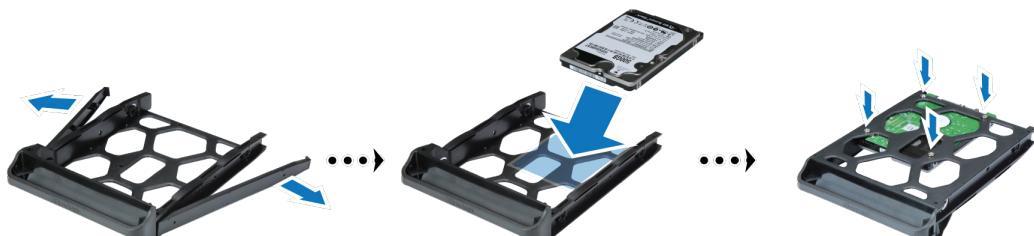
**4** 请确认侧边标示 “UP” 的一面朝上，然后将托盘置入空的硬盘插槽。当托盘锁定到位时，您会听到咔嗒声。
