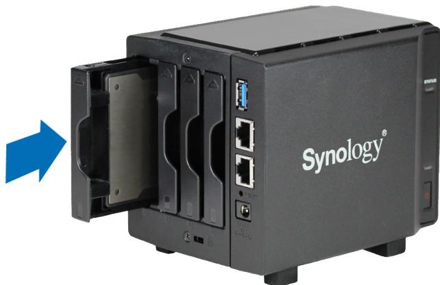
**重要事项：**请确定硬盘托架已完全推入。否则，硬盘可能无法正确运作。
