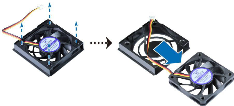
**5** 将新的风扇装入风扇外壳，拧紧螺丝来将风扇固定。
