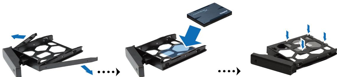
**4** 将装好硬盘的托盘放入空的硬盘插槽。
