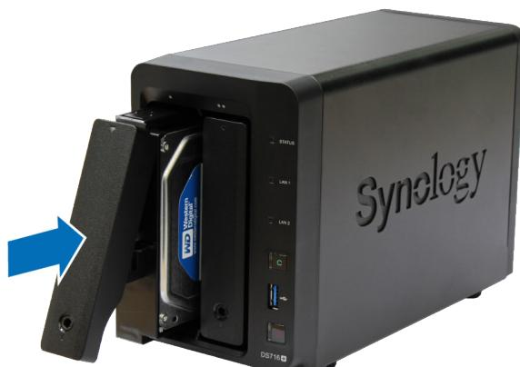
**注：**请确定将托架完全推入。否则，硬盘可能无法正常运作。
