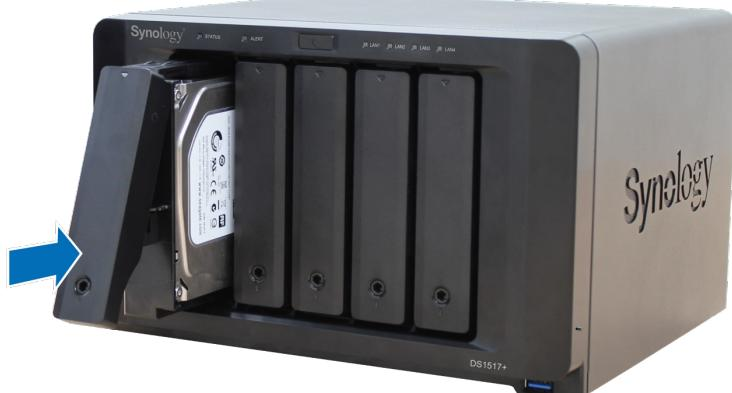
**注：**请确定将托架完全推入。否则，硬盘可能无法正常运作。
