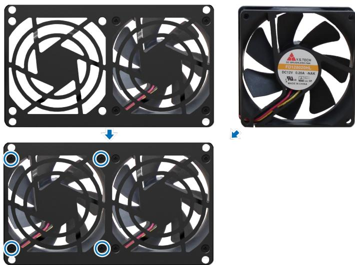
b 将 2 条风扇线缆连接到风扇插座底部附近的接头，然后更换风扇面板。
