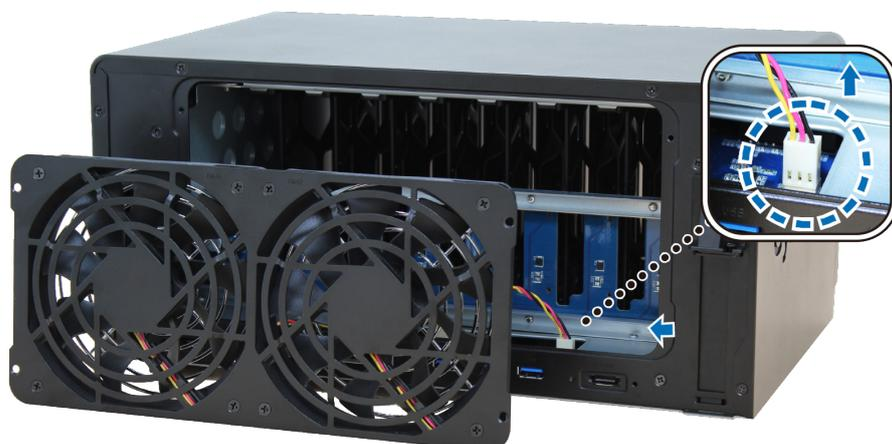
c 松开用来固定故障风扇的 4 颗螺丝，然后卸下风扇。
