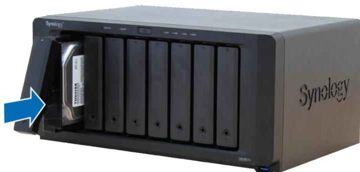
**注：**请确定已将托盘完全推入。否则，硬盘可能无法正常工作。
