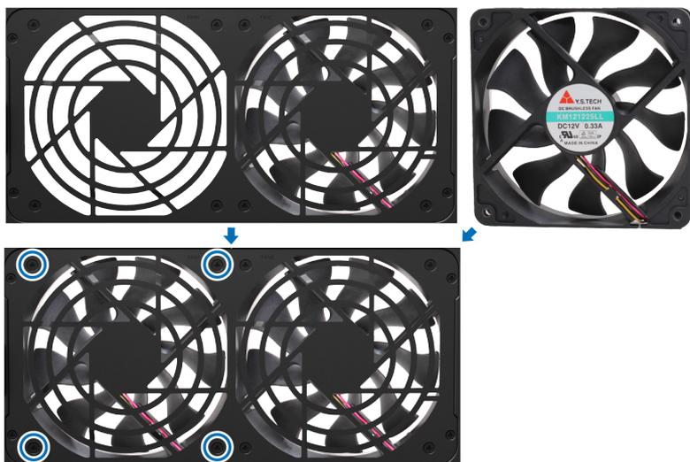
b 将 2 条风扇线缆连接到风扇插座底部附近的接头，然后更换风扇面板。
