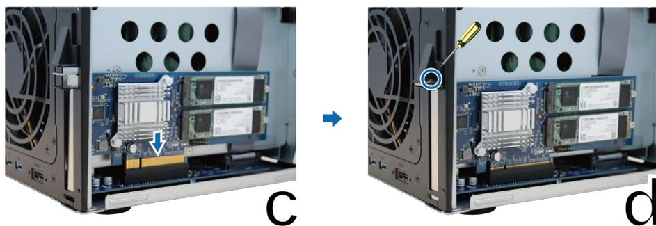
**5 放回在步骤 2 中卸下的上方机壳并拧紧螺丝。**
