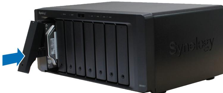
**注：**请务必将托盘完全推入。否则，硬盘可能无法正常运作。
