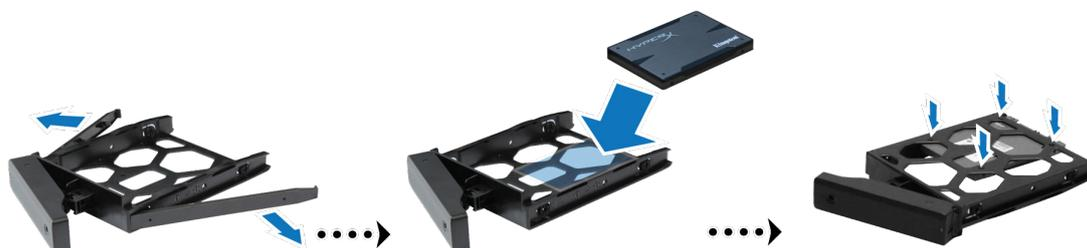
4 将装好硬盘的托盘置入空的硬盘插槽。
