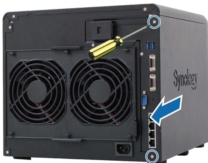
**重要事项：**当您卸下侧盖时，已暴露了内部的敏感组件。插入或移除内存模块时，请避免触碰到除内存外的其他组件。
