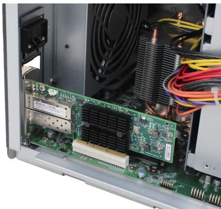
**b** 使用两根手指，牢固且平均地向下按压接口卡和固定片。
