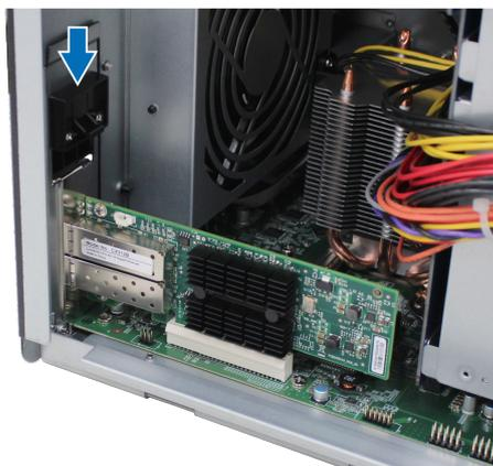
**注：**请确定接头已完全插入。否则，网络接口卡可能无法正常工作。
