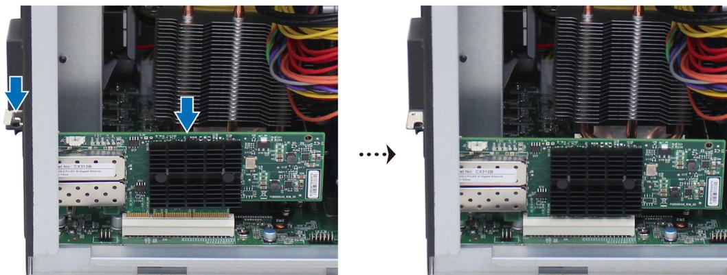
**c** 将固定夹推回以固定新插入的卡。
