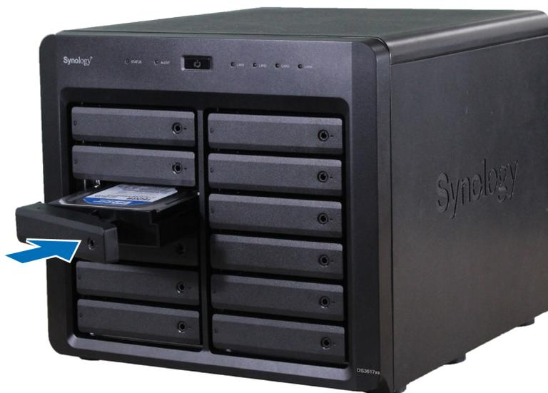
**注：**请确定已将托盘完全推入。否则，硬盘可能无法正常运作。
