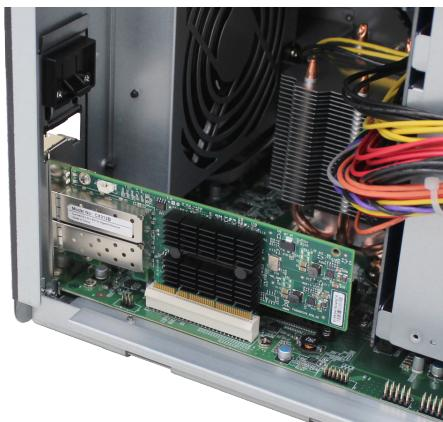
**b** 使用兩根手指，穩固且平均地向下按壓介面卡及介面卡的固定片。
