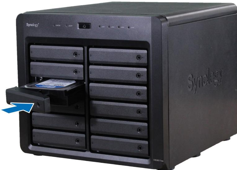
**注意：**請確定已將托盤完全推入。否則，硬碟可能無法正確運作。
