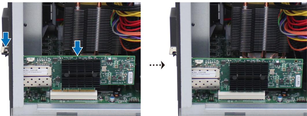
**c** 推回扣鎖來固定新安裝的網路介面卡。
