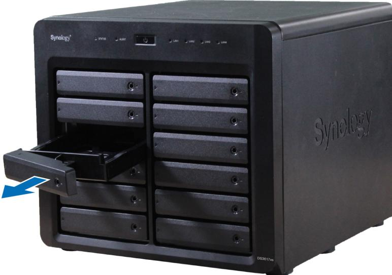
**3 將硬碟放入硬碟托盤中。**
