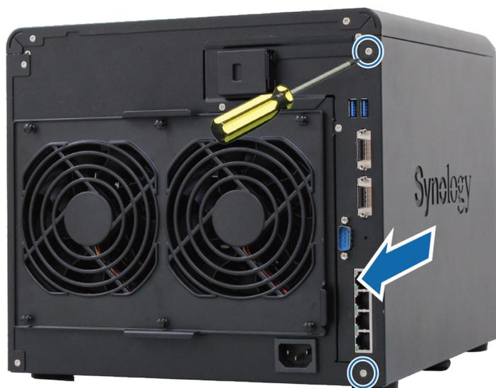
**Importante:** quando viene rimosso il coperchio laterale, vengono esposti i componenti interni sensibili. Evitare di toccare componenti diversi dal gruppo di memoria durante la rimozione o l'aggiunta di un modulo RAM.
