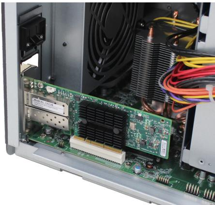
b Com dois dedos, faça uma pressão firme e uniforme para empurrar a placa e o suporte.
