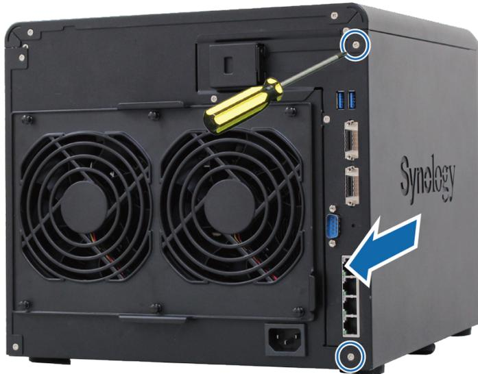
**Importante:** Ao remover a tampa lateral, componentes internos delicados ficarão expostos. Evite tocar em qualquer outra parte que não seja o conjunto da memória ao inserir ou remover um módulo de RAM.
