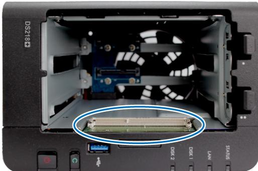
**重要事项：**当您卸下硬盘托架时，已暴露了内部的敏感组件。移除或添加内存模块时，请避免触碰到除内存外的其他组件。
