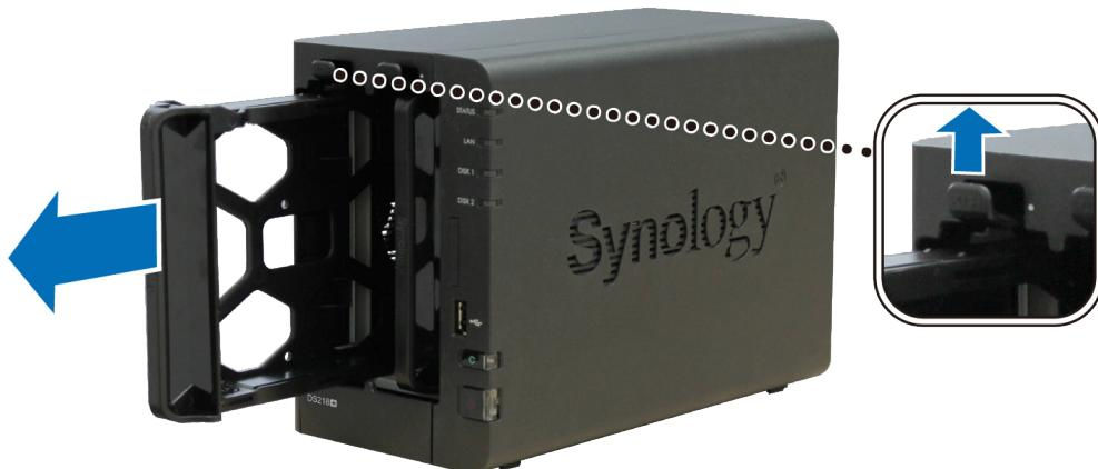
**3** 將硬碟放入硬碟托盤中。
