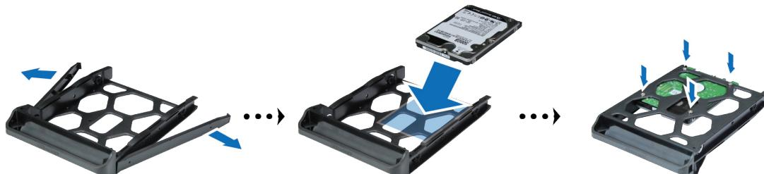
**4** 将装好硬盘的托盘置入空的硬盘插槽。请确认侧边标示“UP”的一面朝上，然后将托盘置入空的硬盘插槽。当托架锁定到位时，您会听到咔嗒声。
