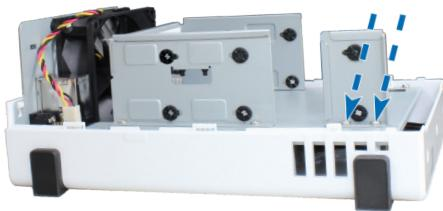
**b** 将硬盘滑入硬盘插槽，并将其推入直至与 SATA 接头稳固连接。请使用提供的螺丝来固定硬盘。
