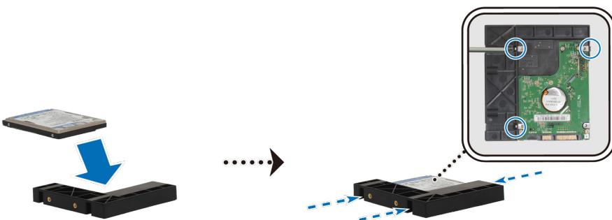
**b** 將 2.5 吋硬碟架滑入硬碟插槽並推入至底，使硬碟接上 SATA 接頭。使用附上的螺絲來固定硬碟架。
