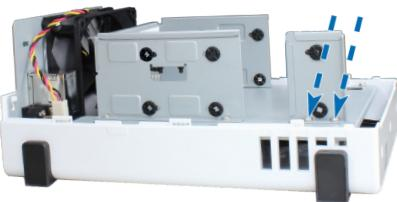
**b** 將硬碟架滑入硬碟插槽並推入至底，使硬碟接上 SATA 接頭。使用附上的螺絲來固定硬碟架。
