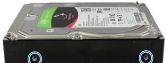
**a** HDD ブラケットを DiskStation に置き、ブラケットを同梱のネジで DiskStation に固定します。
