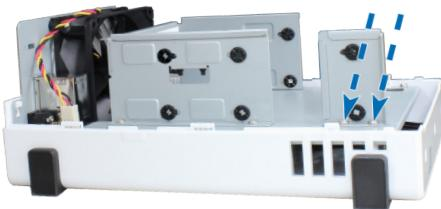
**b** ドライブをハードドライブベイにスライドさせて、SATA コネクタに完全に接続されるまで押し込みます。ドライブを付属のネジで固定します。
