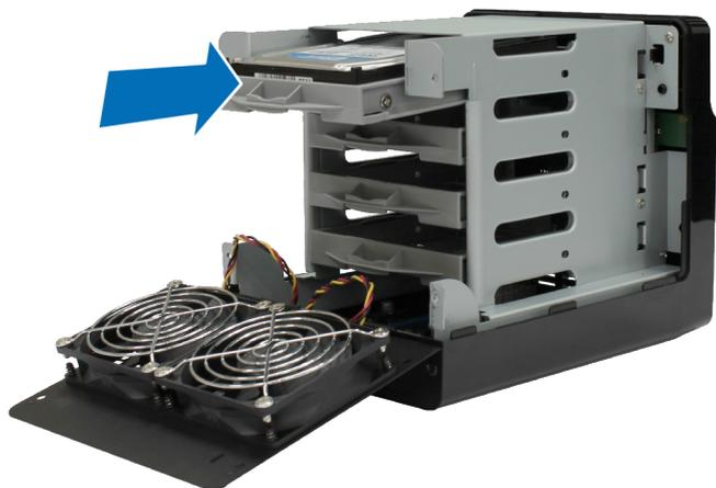
**注：**请确定硬盘托架已完全推入。否则，硬盘可能无法正常工作。
