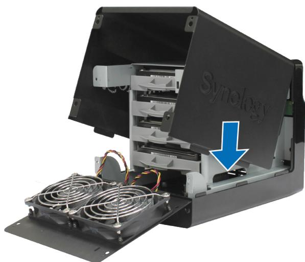
8 关闭后方面板。放置顶盖，并锁紧您在步骤 1 中取下的 4 颗螺丝。
