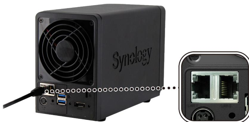
2 连接交流电源适配器至 DiskStation 的电源端口。并将交流电源线一端连接至交流电源适配器，另一端接至插座。
