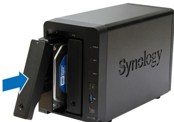
**注：**请务必将托盘完全推入。否则，硬盘可能无法正常工作。
