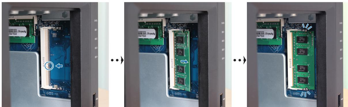
**重要** : メモリ モジュールの端を持つようにして、金色の接触個所に触れないでください。
