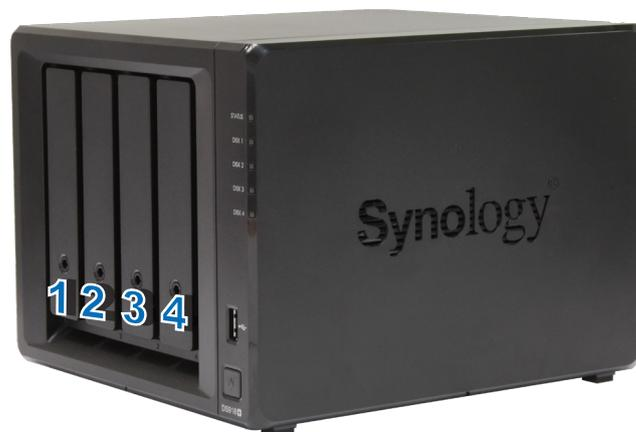
**注意**：RAID ボリュームを構築する場合は、取り付けたすべてのディスクを同じサイズにして、ディスク容量を最も有効に使えるようにしてください。
