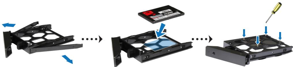
**3** 将硬盘托盘插入到空的硬盘插槽，将其推回，直到您听到咔嗒一声，表明托盘锁定到位。
