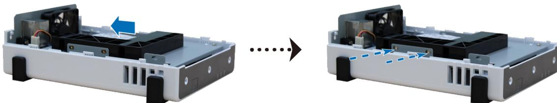
3 装回上方机壳，然后锁紧后面板上的螺丝。
