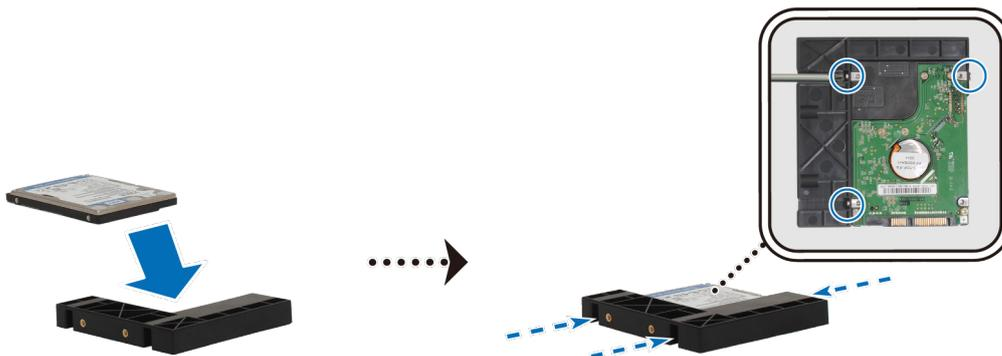
b 将 2.5 吋硬盘托架滑入硬盘插槽，并将其推入直至与 SATA 接头稳固连接。请使用提供的螺丝来固定硬盘托架。
