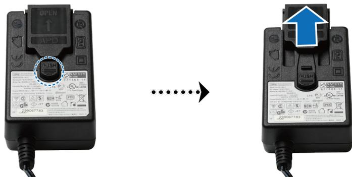
2 装入提供的插头适配器，并向下推动使其滑入插槽。请注意，DiskStation 随附的插头适配器会根据所在的地区将有所不同。下图仅供参考。
