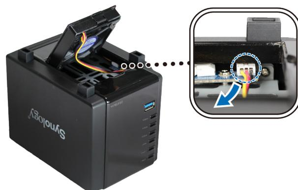
4 卸下风扇外壳上的螺丝并将故障风扇取出。
