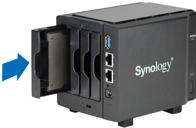
**重要事项：**请确定硬盘托架已完全推入。否则，硬盘可能无法正常工作。
