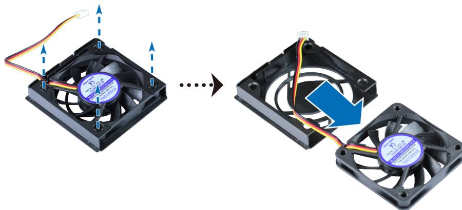
5 将新的风扇滑入风扇外壳。拧紧螺丝来将风扇固定。
