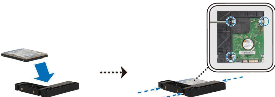
**b** 将 2.5 吋硬盘托架滑入硬盘插槽，并将其推入直至与 SATA 接头稳固连接。用提供的螺丝来固定硬盘托架。
