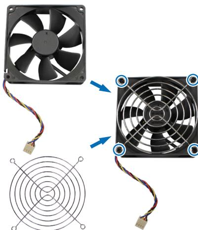
**b** 将风扇外壳 ( 风扇中的风扇线缆指向右下角 ) 装到新风扇上 , 然后拧紧螺丝以固定风扇外壳。
