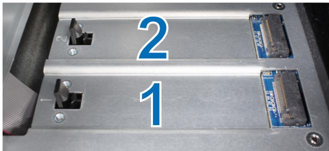
**注：**请按住 SSD 模块的边缘，并避免触碰到金属接头。
