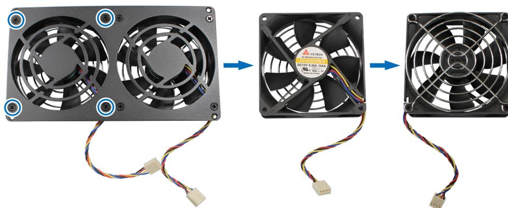
d 从故障风扇上卸下固定风扇外壳的螺丝。
