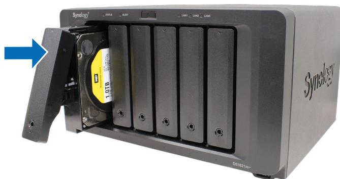
**注：**请确定硬盘托盘已完全推入。否则，硬盘可能无法正常工作。
