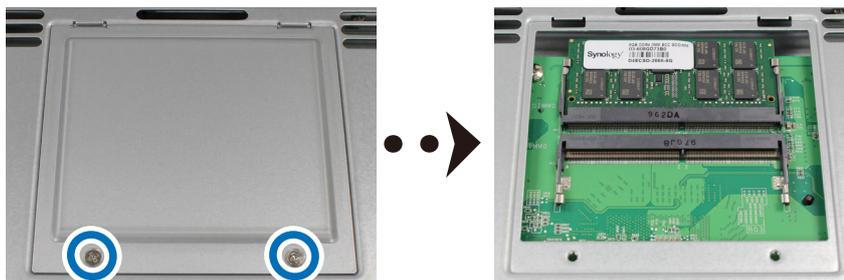
**注：**当您卸下护盖时，即已暴露内部的敏感组件。移除或添加内存时，请避免触碰到除内存外的其他组件。
