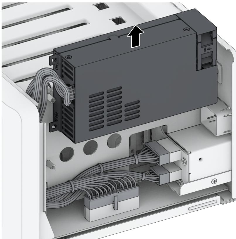
4. 从主板和 HDD 背板上的插槽中拔下电源接头。
