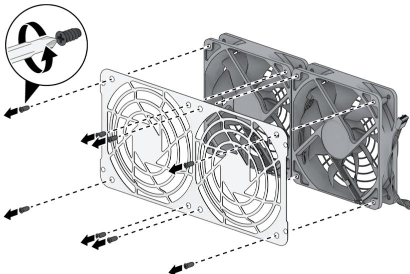
8. 从风扇护罩上卸下固定风扇的螺丝。
