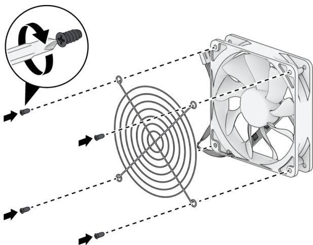
2. 拧紧将风扇固定到风扇护盖的螺丝。
