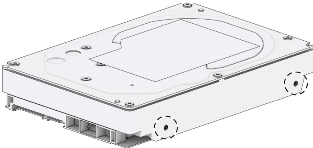
a. 将 HDD 支架放到 Synology NAS 上，使用提供的螺丝将支架紧固到 Synology NAS 上。
