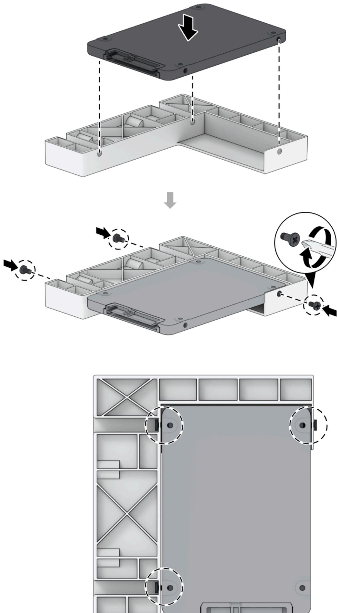
b. 将 2.5 英寸硬盘托架滑入硬盘插槽，并将其推入直至与 SATA 接头稳固连接。请使用提供的螺丝来固定硬盘托架。
