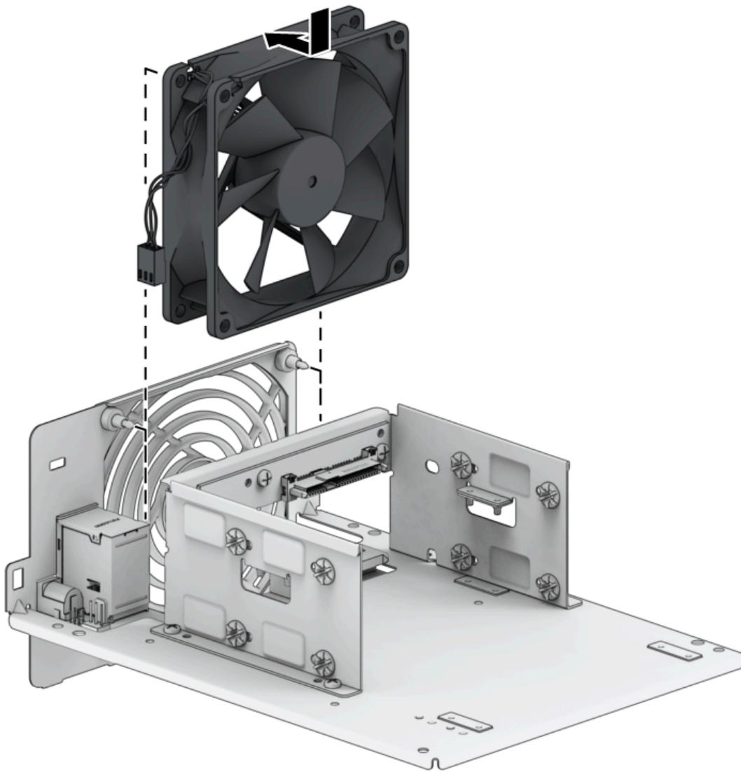
2. 插回风扇接头，然后将四个橡胶垫重新安装到风扇上。
