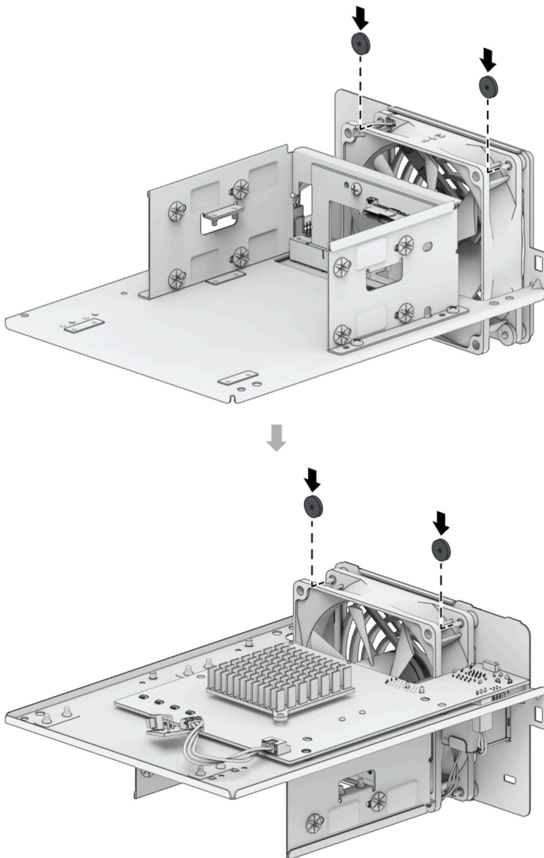
3. 将四颗螺丝重新安装到金属框架中，并重新安装固定电源按钮背板的螺丝。确保金属框架正确卡入到塑料外壳上。
