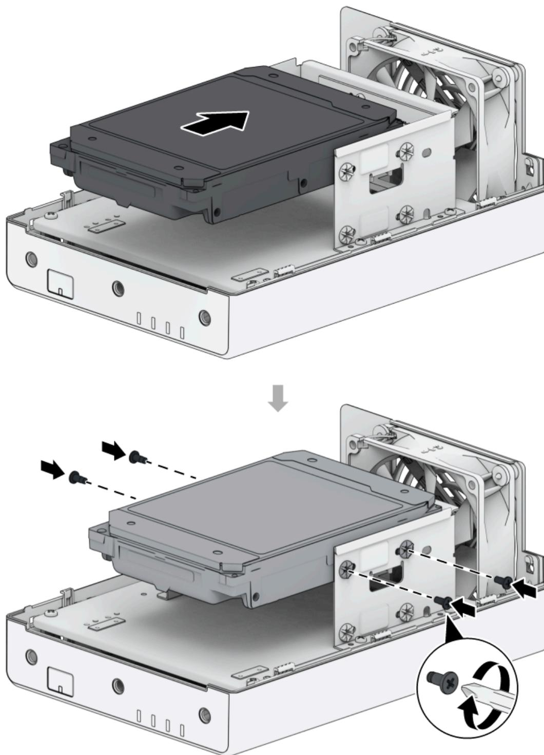
。对于每侧有 2 个螺丝孔的 3.5 英寸硬盘（以下所示）：
